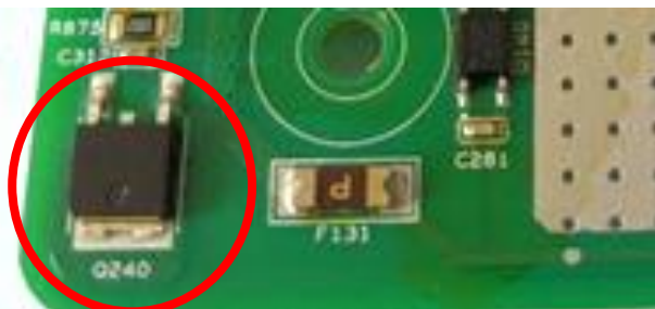
Obr. 9: Detailný pohľad na riadiaci modul BESS – Kritický prvok.
